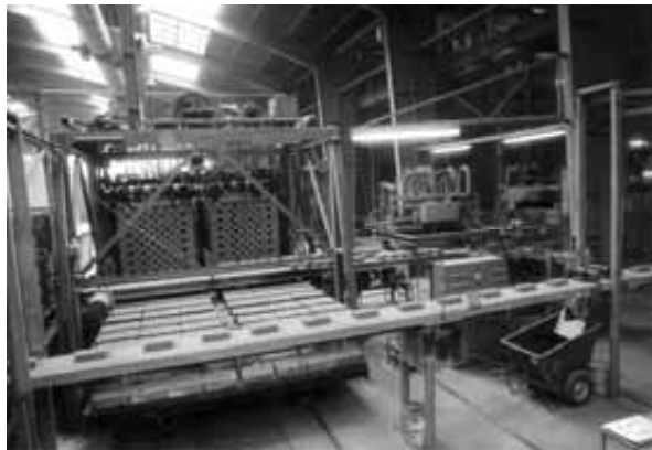
Automatisches Setzen der Klinkersteine.
